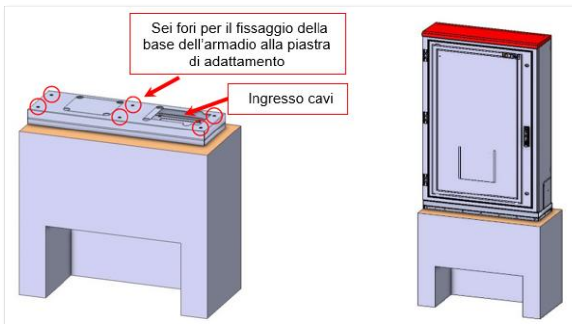
Figura 11: PREDISPOSIZIONI PER LA POSA DELL'ARMADIO SUL BASAMENTO
